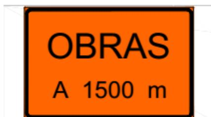
Figura 2 - Placa Advertindo sobre obras na pista (IO-1)
