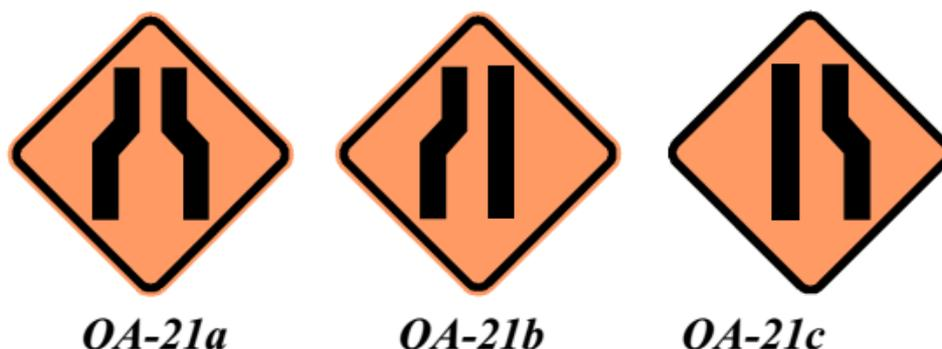
Figura 1 - Placa de estreitamento da pista ao centro, à esquerda e à direita.
