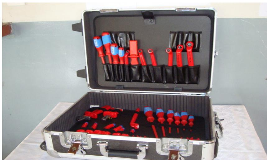
**Figura 14-Foto de uma maleta de ferramentas isoladas na UHE XXX**
