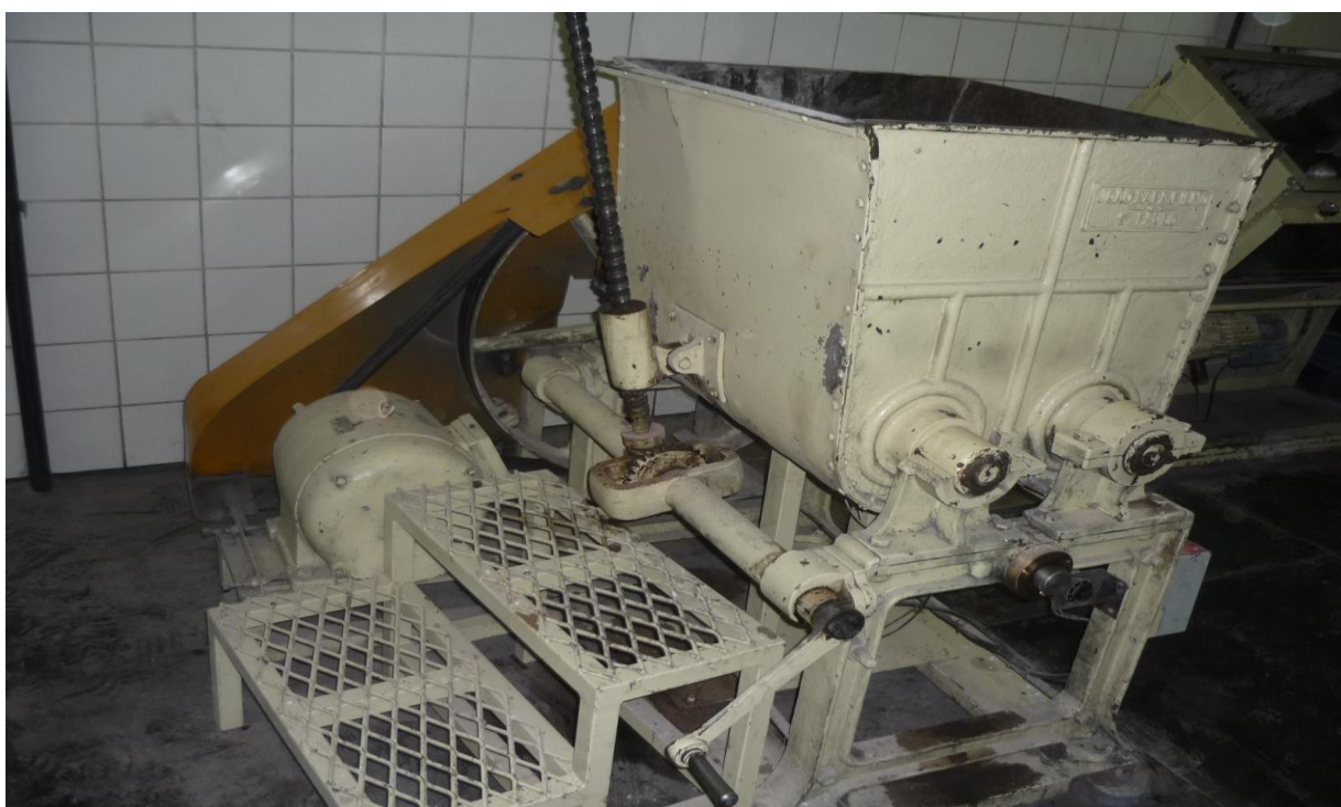
Figura 4 - Bateadeira elétrica. Fonte: próprio autor
