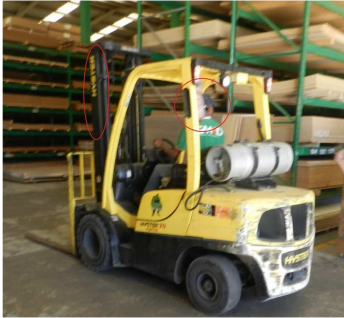
Figura 21: Ausência de sinalização das empilhadeiras
