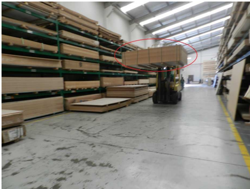
Figura 22: Uso inadequado da empilhadeira.
