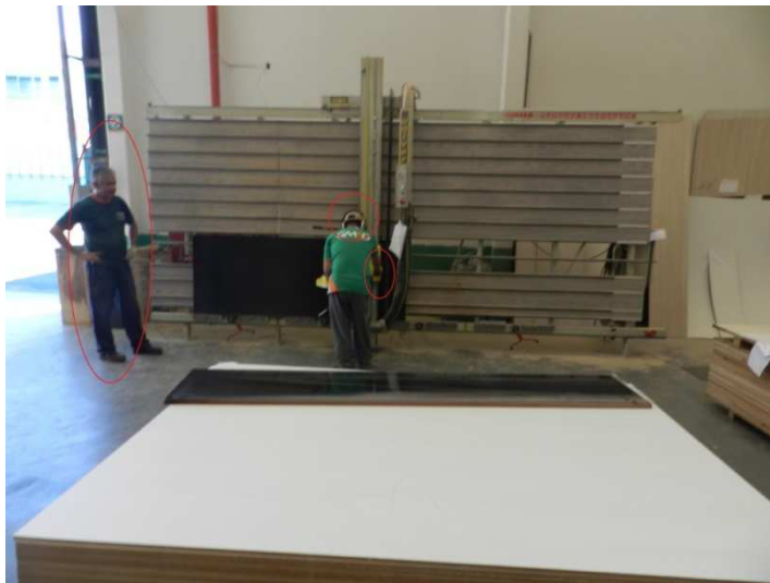
Figura 20: Falta do uso de EPI's.
