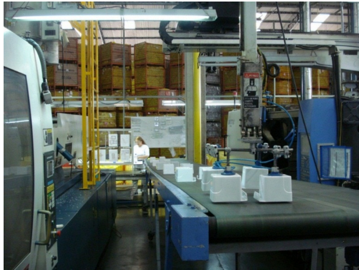
Figura 8 – Peças depositadas na esteira deslizante Fonte: Autoria própria.
