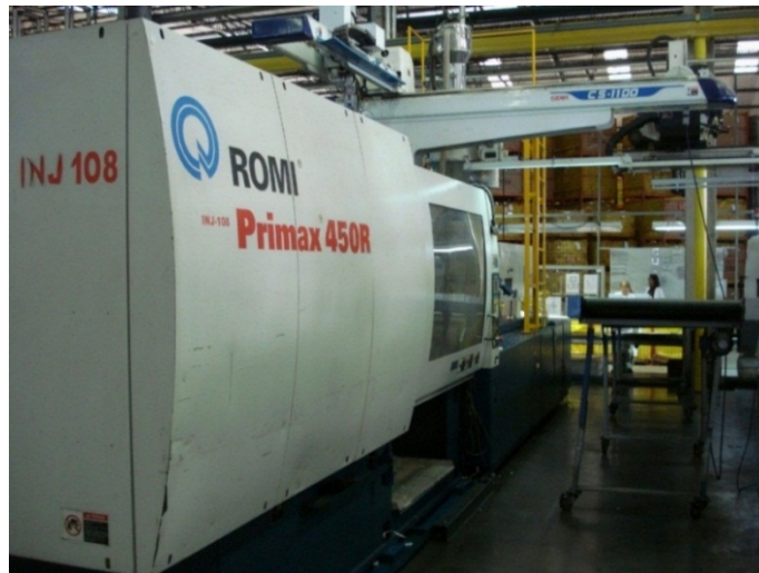
Figura 6 – Moldagem por injeção das peças plásticas Fonte: Autoria própria.
