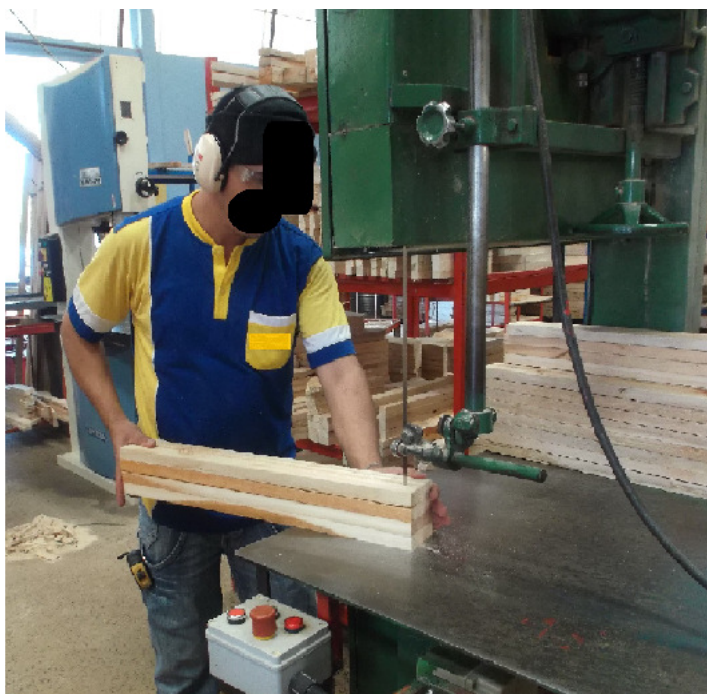
Figura 17 – Corte da madeira sem luva de aço. Fonte: Autoria própria.
