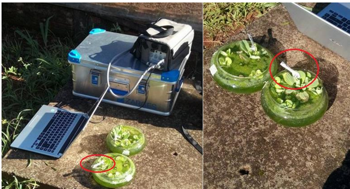
Figura 8 - Equipamento portátil PAM-2500 e detalhe do clipe foliar utilizado para adaptação no escuro.
