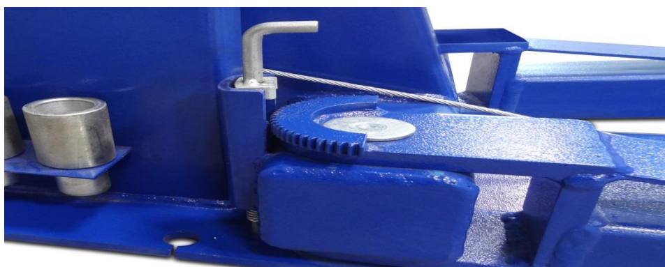
Figura 20: Modelo de dispositivo de segurança para os braços. Fonte: Rodavele elevadores (2017).
