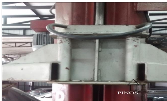
Figura 13: Acoplador dos braços do elevador. Fonte: autor (2017).
