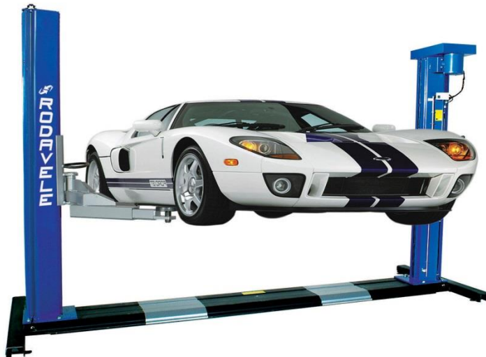
Figura 6: Elevador de colunas sistema eletromecânico. Fonte: Rodavele elevadores (2017).
