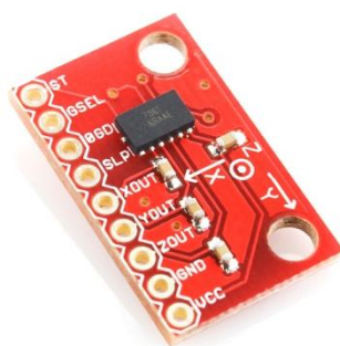
Figura 4 – Placa com acelerômetro MMA7361
