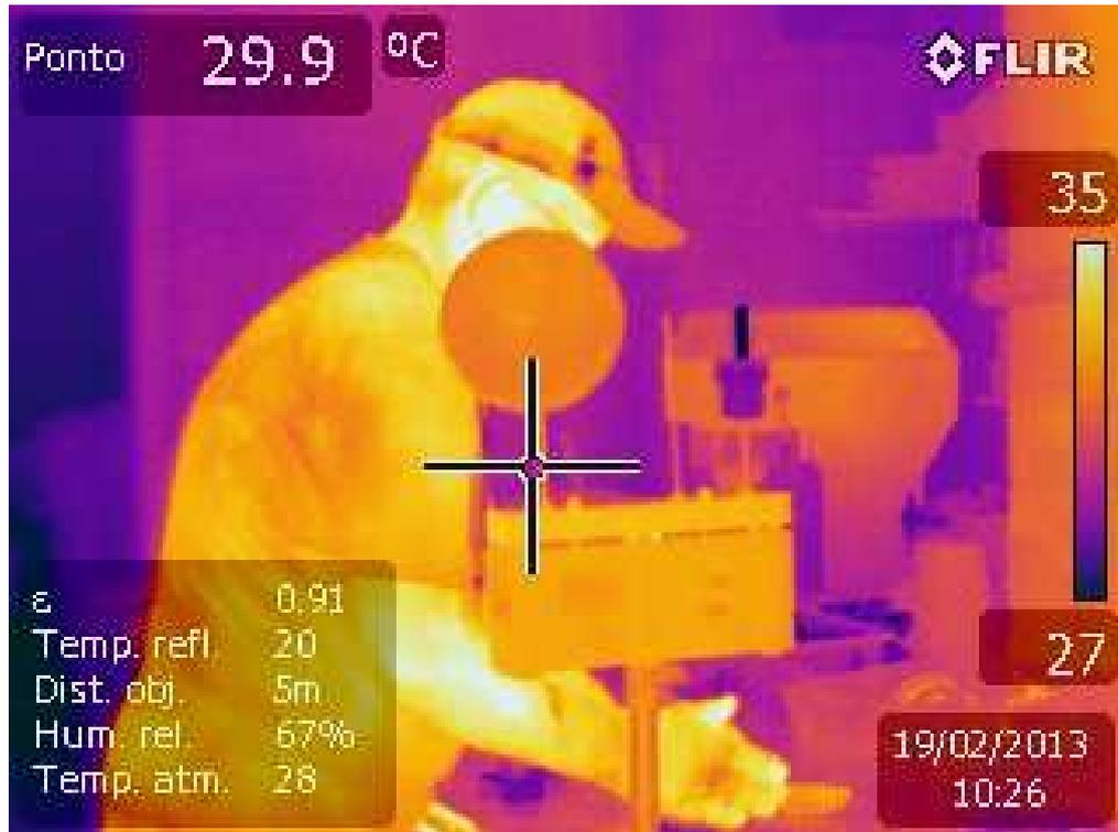
FIGURA 44: TERMOGRAMA MOSTRANDO O GRADIENTE DE TEMPERATURA DA MESA DE RECHEIOS: 27° a 35°. A CRUZ INDICA A TEMPERATURA CAPTURADA DE 29,9° C. FONTE: O AUTOR, 2013.
