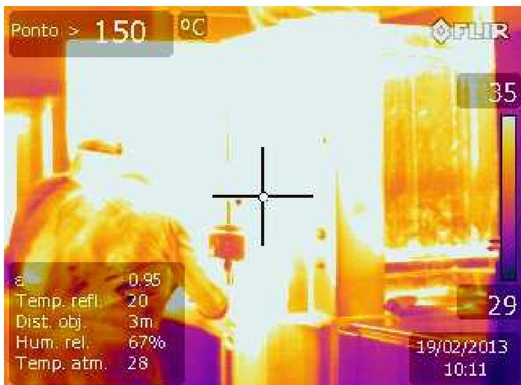
FIGURA 33: TERMOGRAMA MOSTRANDO O GRADIENTE DE TEMPERATURA DO FORNO: 29° a 35°. A CRUZ INDICA A TEMPERATURA CAPTURADA DE 150° C DO INTERIOR DO FORNO. FONTE: O AUTOR, 2013.
