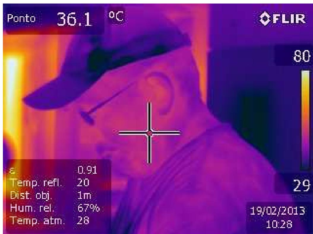
FIGURA 41: TERMOGRAMA MOSTRANDO O GRADIENTE DE TEMPERATURA DO POSTO DE TRABALHO : 29° a 80°. A CRUZ INDICA A TEMPERATURA CAPTURADA DE 36,1° C.
