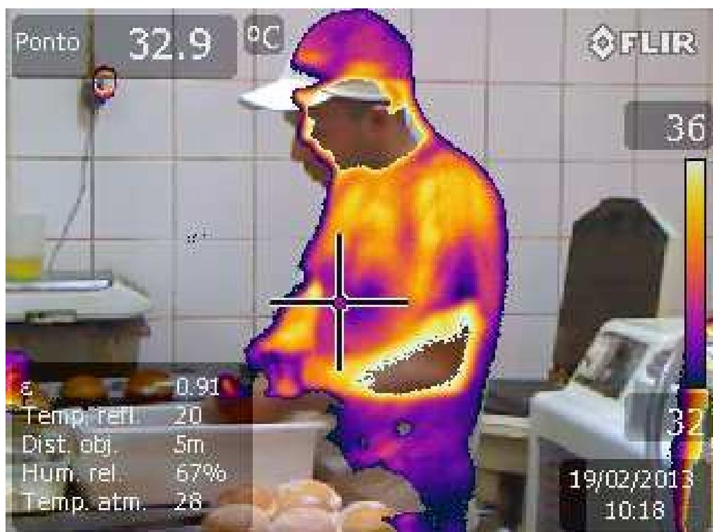
FIGURA 39: TERMOGRAMA MOSTRANDO O GRADIENTE DE TEMPERATURA: 32° a 36°. A CRUZ INDICA A TEMPERATURA CAPTURADA DE 32,9° C.
