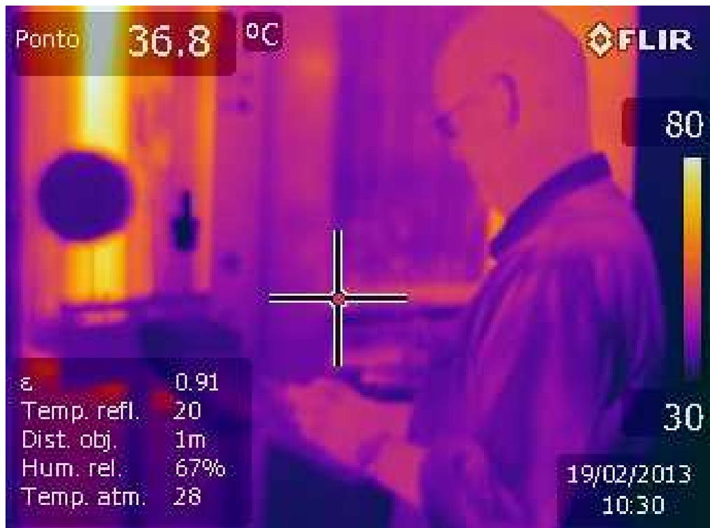
FIGURA 47: TERMOGRAMA MOSTRANDO O GRADIENTE DE TEMPERATURA DA CIRCULAÇÃO: 30° a 80°. A CRUZ INDICA A TEMPERATURA CAPTURADA DE 36,8° C.
