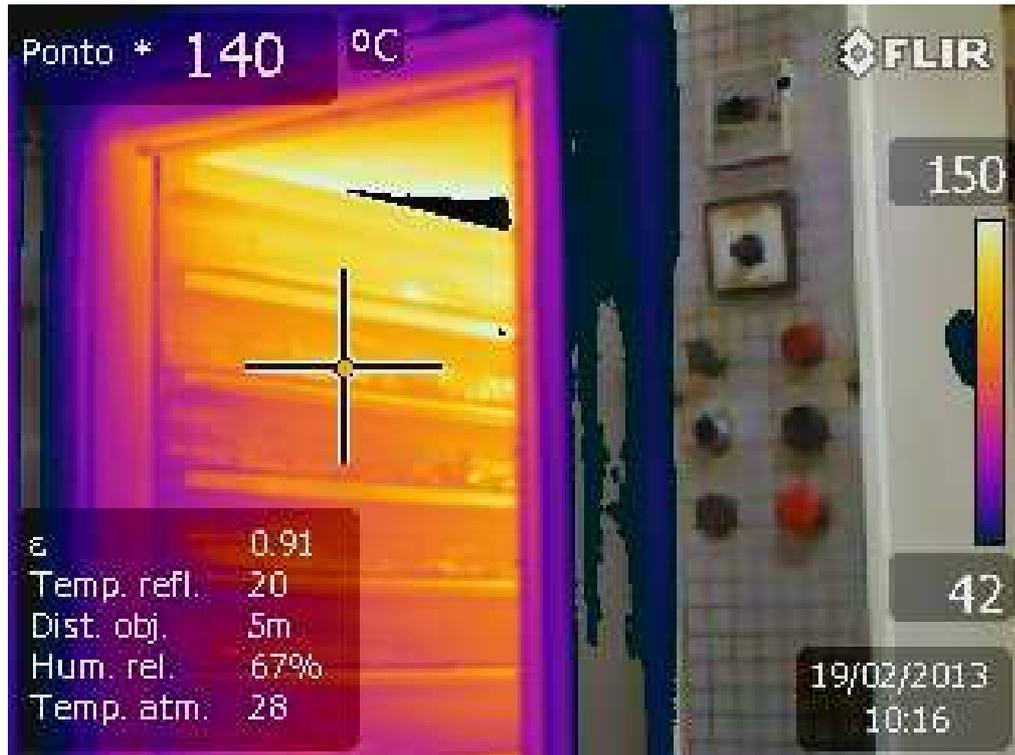
FIGURA 34: TERMOGRAMA MOSTRANDO O GRADIENTE DE TEMPERATURA DO FORNO: 42° a 150°. A CRUZ INDICA A TEMPERATURA CAPTURADA DE 140° C.
