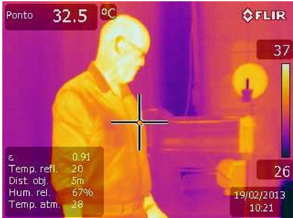
FIGURA 46: TERMOGRAMA MOSTRANDO O GRADIENTE DE TEMPERATURA DO CILINDRO: 26° a 37°. A CRUZ INDICA A TEMPERATURA CAPTURADA DE 32,5° C.
