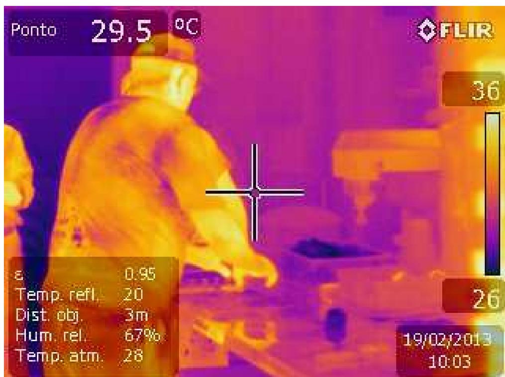
FIGURA 43: TERMOGRAMA MOSTRANDO O GRADIENTE DE TEMPERATURA DO POSTO DE TRABALHO MESA DE RECHEIOS: 26° a 36°. A CRUZ INDICA A TEMPERATURA CAPTURADA DE 29,5° C.
