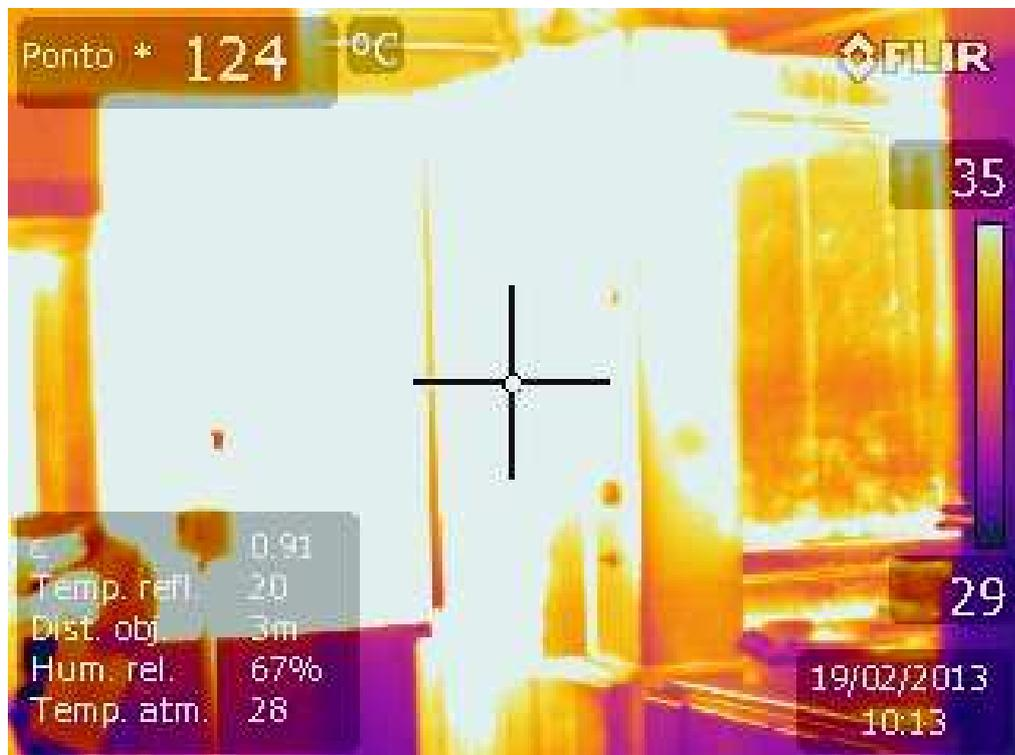
FIGURA 35: TERMOGRAMA MOSTRANDO O GRADIENTE DE TEMPERATURA DO FORNO: 29° a 35°. A CRUZ INDICA A TEMPERATURA CAPTURADA DE 124° C.
