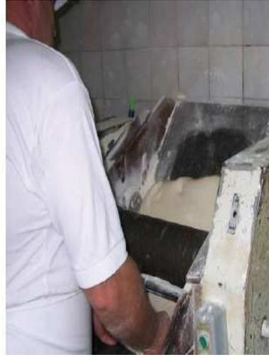
FIGURA 10: HOMOGENEIZAÇÃO EM CILINDRO.
