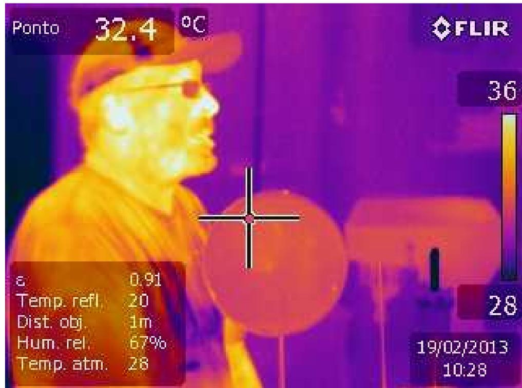
FIGURA 40: TERMOGRAMA MOSTRANDO O GRADIENTE DE TEMPERATURA DO POSTO DE TRABALHO : 28° a 36°. A CRUZ INDICA A TEMPERATURA CAPTURADA DE 32,4° C.
