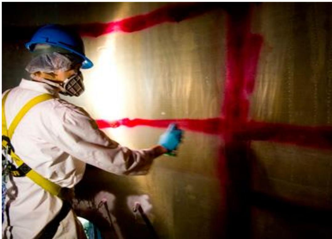
**Figura 9 - Ensaio de líquido penetrante**
