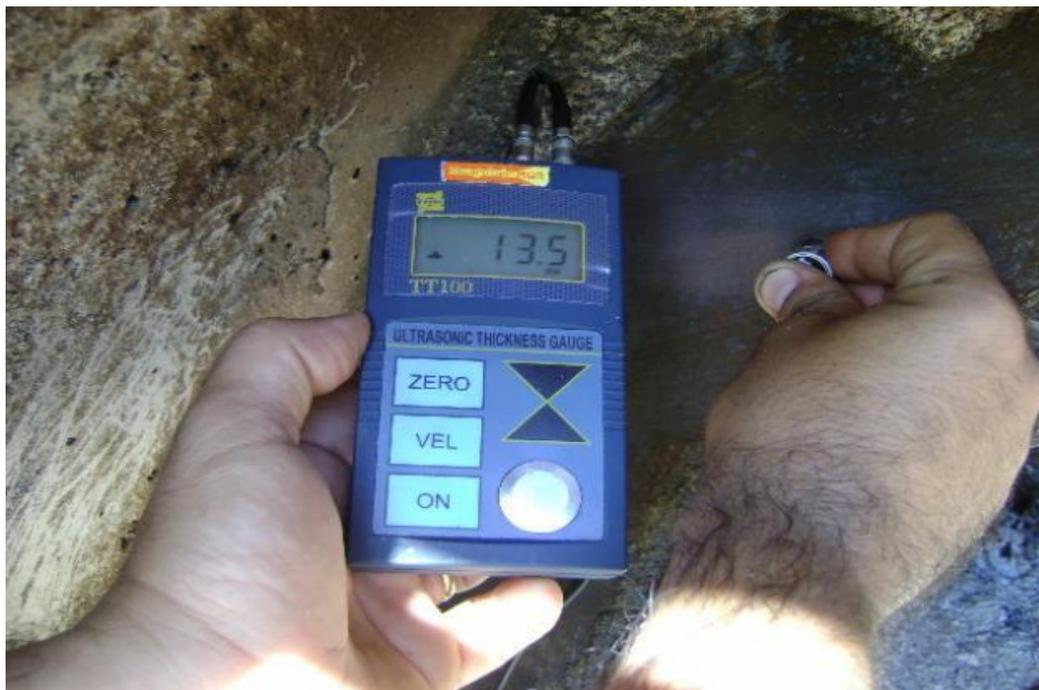
**Figura 10 - Medição de espessura por ultrassom**
