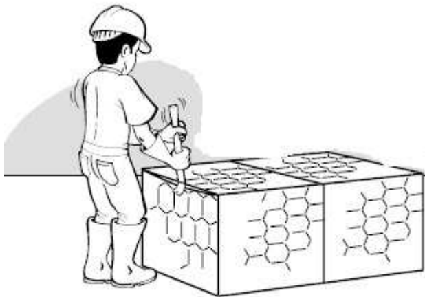
Figura 20 – Detalhe da etapa de fechamento do gabião tipo caixa
