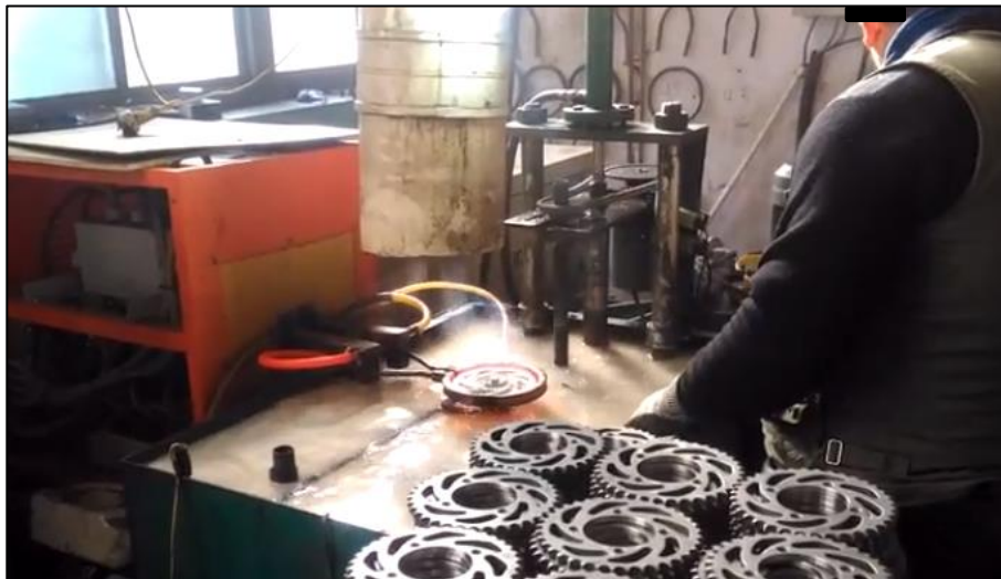
Figura 7 - Quinta máquina analisada, processo de têmpera por indução. Fonte: Autoria Própria (2018).
