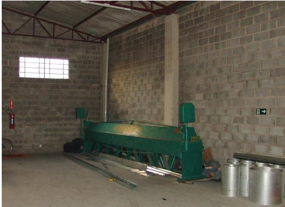
Figura 20: Galpão de produção com destaque para máquina de dobragem das chapas de aço. (FIRETTI, 2012)
