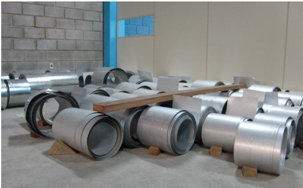
Figura 21: Armazenamento de bobinas de chapa de aço. (FIRETTI, 2012)
