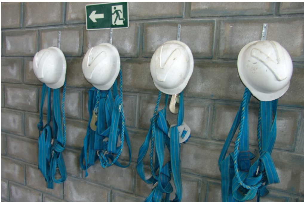
Figura 23: Cinturões tipo paraquedistas e capacetes utilizados na rotina de instalação de calhas. (FIRETTI, 2012)
