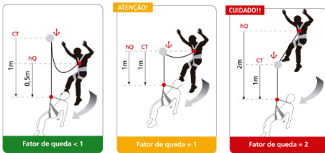
Figura 17: Fator de queda. (ULTRASAFE, 2013)
