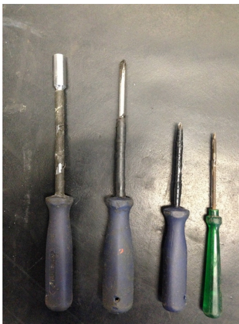
Figura 10 - Exemplo de ferramentas inadequadas Fonte: o autor, 2015
