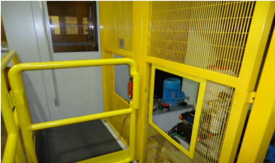
Figura 23 – Portão com sensor para desligamento automático
