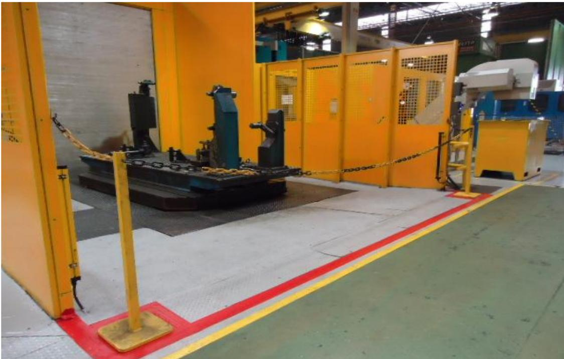
Figura 26 – Cortina de luz instalada no centro de usinagem
