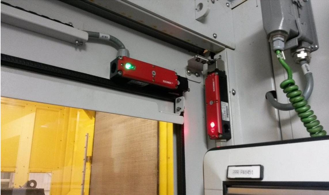
Figura 24 – Detalhe do sensor de segurança na porta do equipamento
