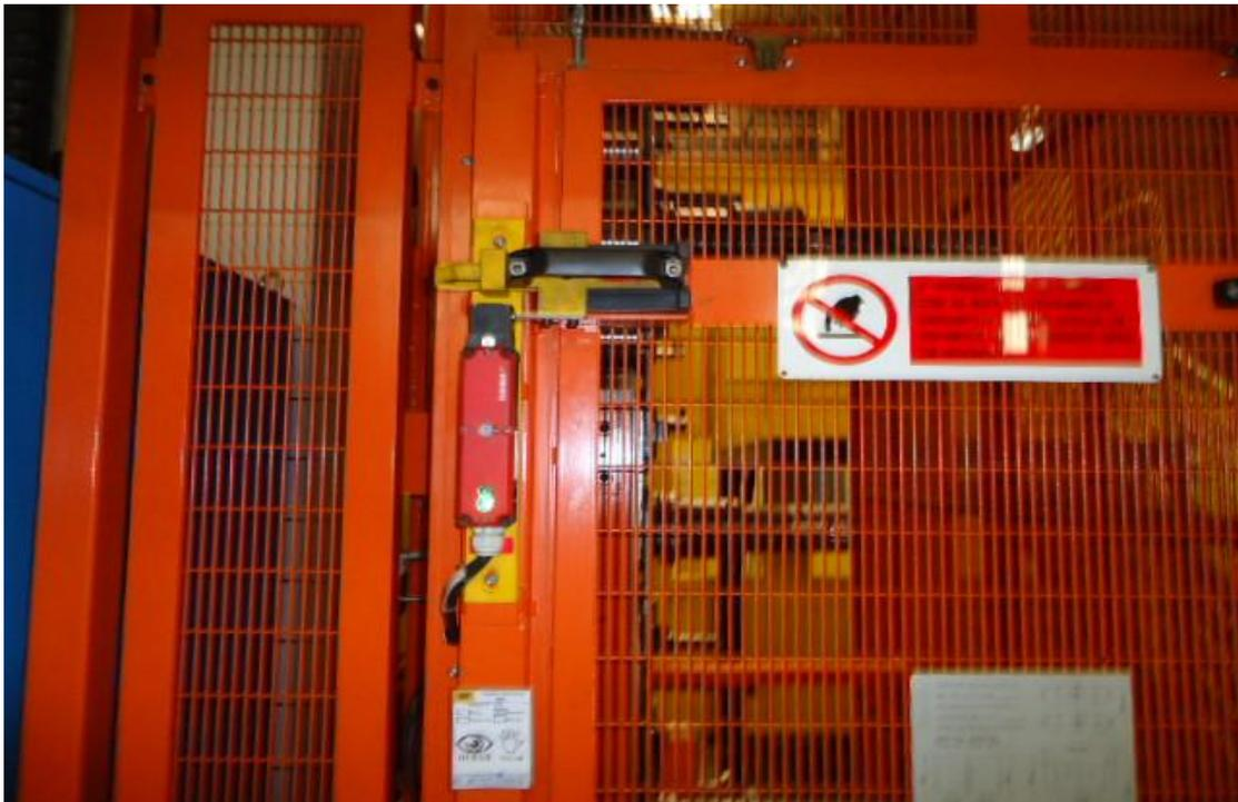
Figura 25 – Portão de ferramentas com sensor para desligamento automático
