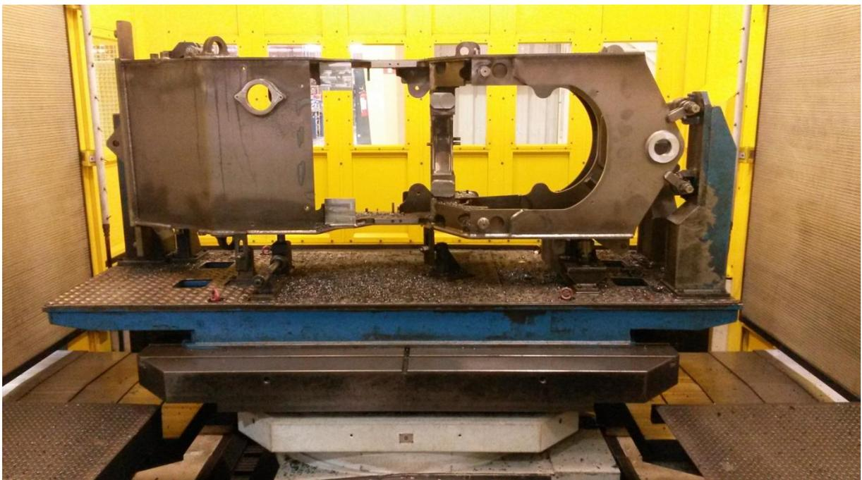
Figura 17 – Centro de usinagem com um chassi
