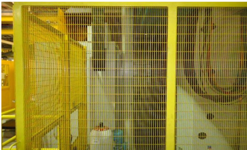
Figura 22 – Distância entre áreas da tela de proteção no centro de usinagem
