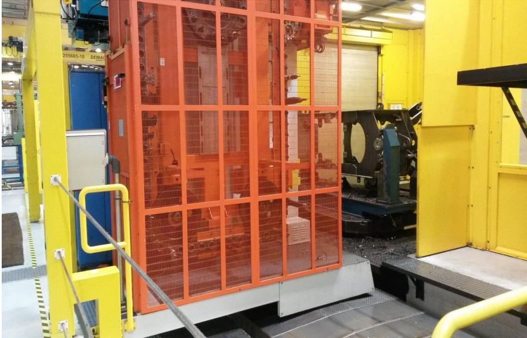
Figura 21 – Tela de proteção no ferramental magazine do centro de usinagem
