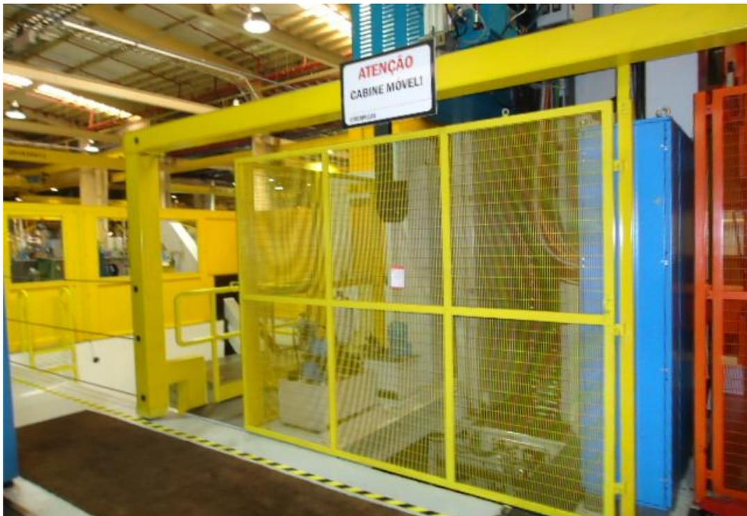
Figura 20 – Tela de proteção no centro de usinagem
