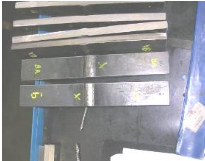
Figura 3.12 – Fotografia de amostras serradas para confecção de corpos-de-prova ensaio de tração.
