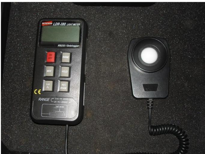
**Figura 19: Medidor de iluminância Instrutherm LDR-380**
