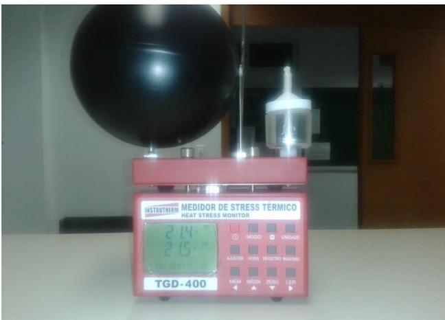
**Figura 18: Medidor de temperatura Instrutherm TGD-400**
