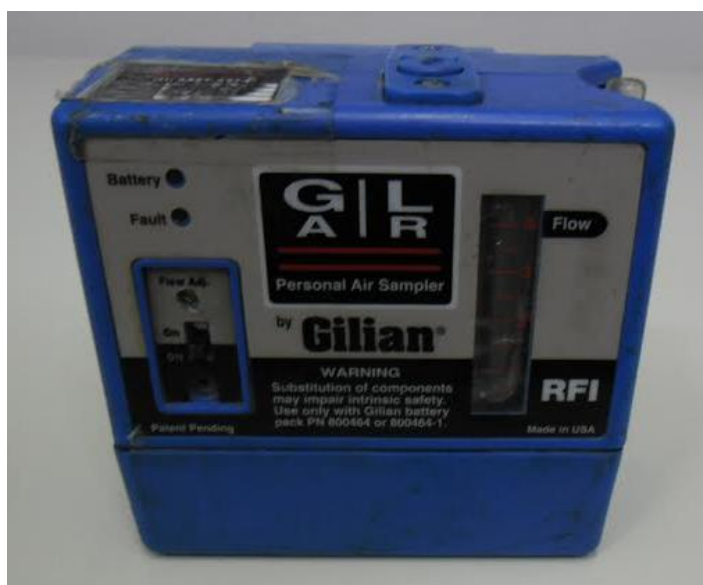
Figura 1- Bomba gravimétrica utilizada na amostragem Fonte: Autoria própria
