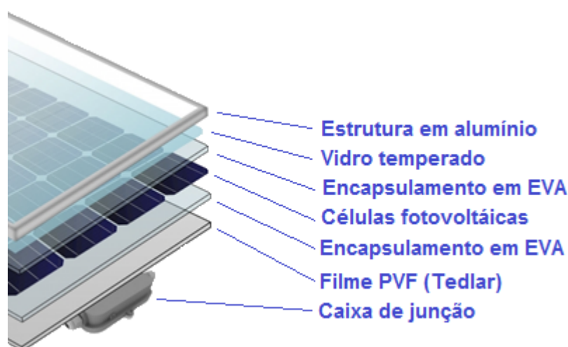
Figura 7 – Partes que compõem um painel fotovoltaico Fonte: Autoria própria
