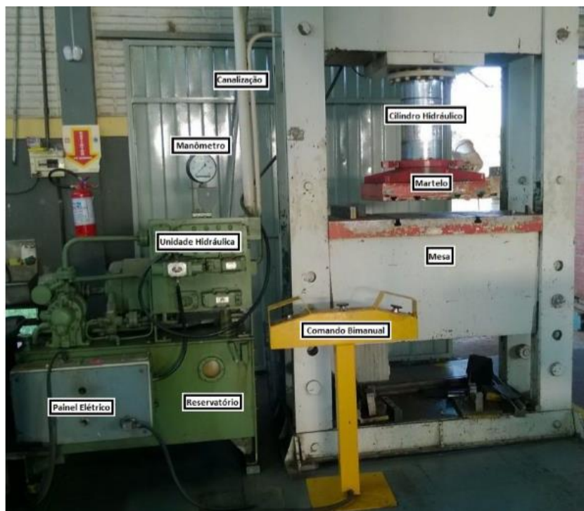
Figura 4 – Partes de uma Prensa Hidráulica. Fonte: Schulz, 2015.
