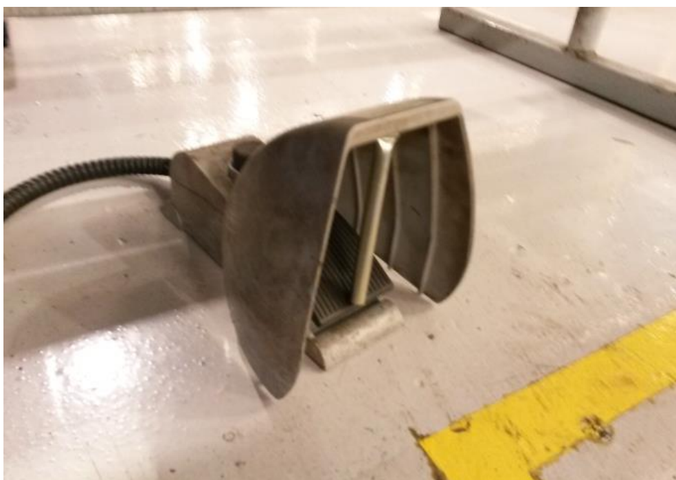
Figura 18 – Burla do sistema feita pelos operadores da máquina. Fonte: Autoria própria.
