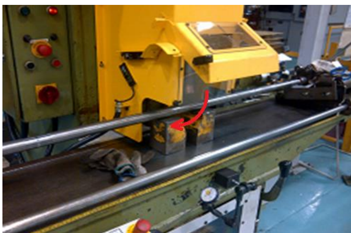
Figura 14 – Portinhola móvel para enclausuramento da zona de prensagem. Fonte: Laudo de adequação da empresa que realizou a adequação.
