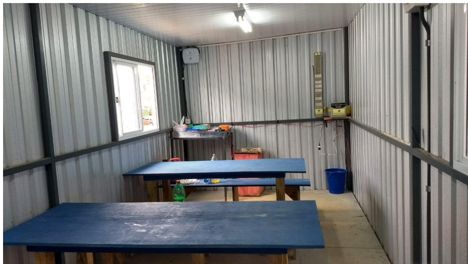
Figura 38: Obra B. Refeitório disposto de mesas, marmiteiro e lixeira. Pode-se observar a janela para iluminação e ventilação.
