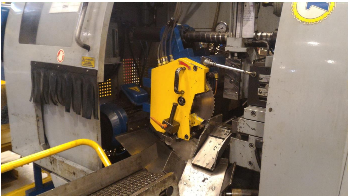
Figura 15 - Módulo de corte da máquina com porta aberta. Fonte: Autoria Própria
