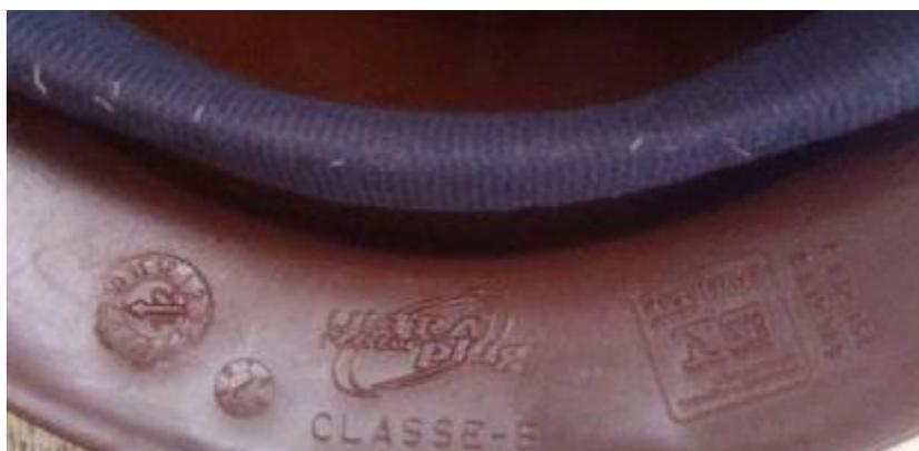
**Figura 5 – Marcação de identificação de capacete de segurança classe B.**
