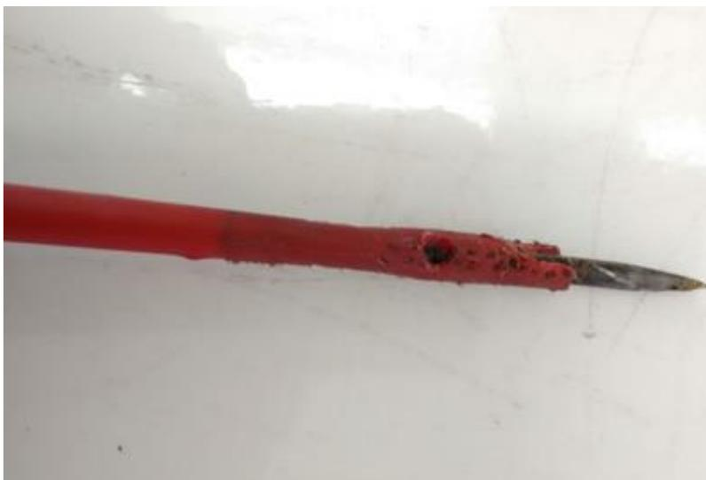
**Figura 15 – Ferramenta isolante reprovada em ensaio dielétrico.**
