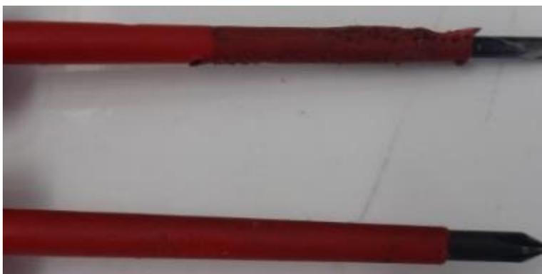
**Figura 16 – Ferramenta isolante em diferentes condições do material isolante.**
