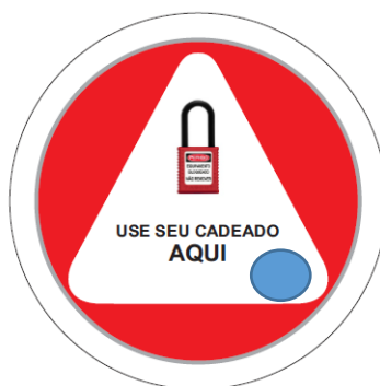
Figura 21 Adesivo orientativo de bloqueio com cadeado Fonte: A autora, 2018
