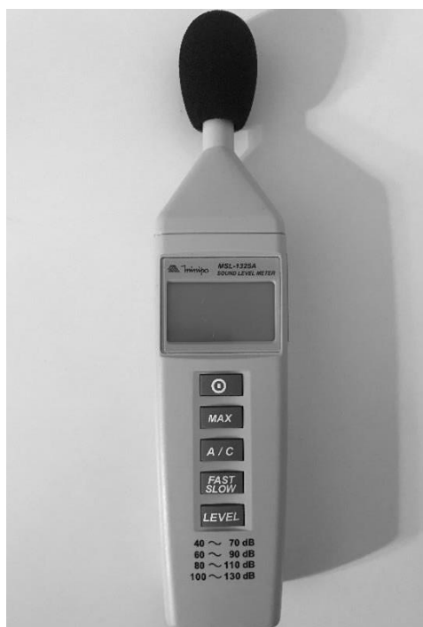
Figura 5 - Decibelímetro marca Minipa modelo MSL-1325A utilizado nas medições. Fonte: A autora, 2018.
