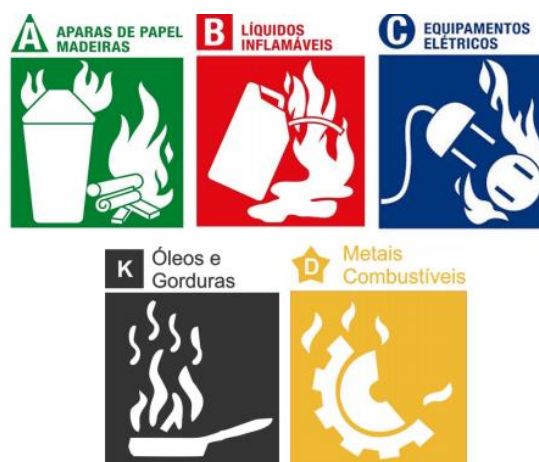
Figura 03 – Cores e formas de simbologia de acordo com a classe de fogo.
