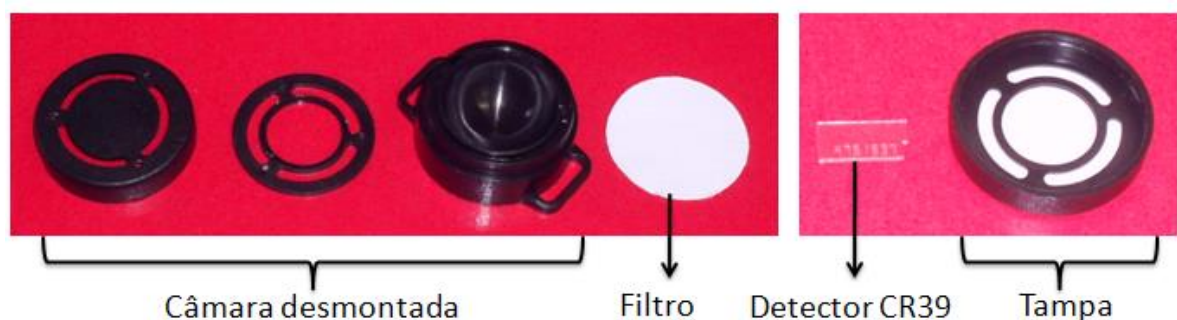
Figura 19 - Câmara desmontada utilizada na medição de concentração de radônio em ambientes indoor
