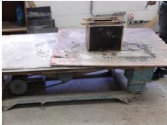
Adensamento na mesa vibratória
