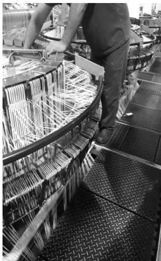
Figura 13- Vibração de corpo inteiro nas plataformas dos teares.
