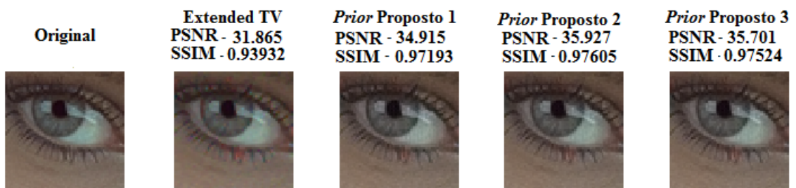
Figura 26: No canto superior esquerdo se encontra a imagem original que gerou os dados com ruído que foram utilizados para a reconstruções nas outras posições com captura por padrão CYGM, com os resultados dos Priors propostos, e o algoritmo proposto (SAITO; KOMATSU, 2008).
