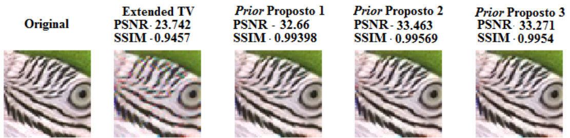
Figura 22: No canto superior esquerdo se encontra a imagem original que gerou os dados que foram utilizados para a reconstruções nas outras posições com captura por padrão RGBW, com os resultados dos Priors propostos, e os algoritmo proposto (SAITO; KOMATSU, 2008).
