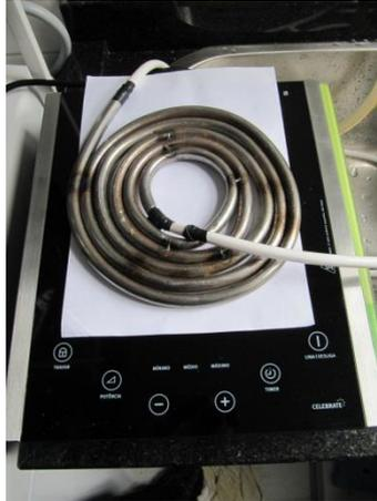
**Fotografia 10 - Serpentina acoplada ao dispositivo de aquecimento por indução**
