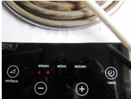
**Fotografia 11 - Controles de Potência do sistema de aquecimento por indução**
