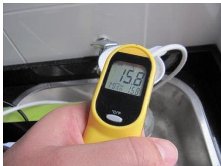
**Fotografia 12 - Medição da temperatura da água com termômetro infravermelho**
