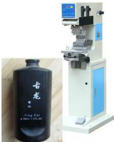
Figura 15 – Tampografia: Equipamento e embalagem impressa
