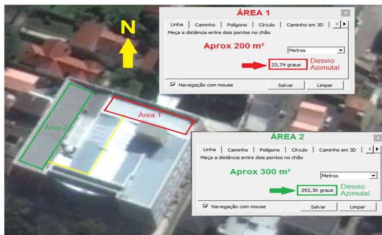
Figura 17 - Desvio Azimutal dos planos de telhado
