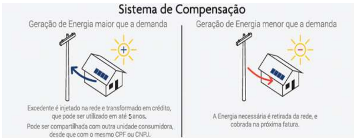
Figura 12 - Sistema de compensação
