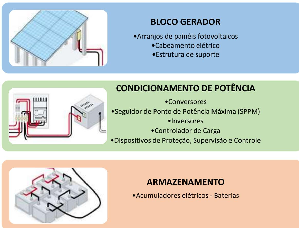
**Figura 10: Principais componentes de um sistema fotovoltaico**
