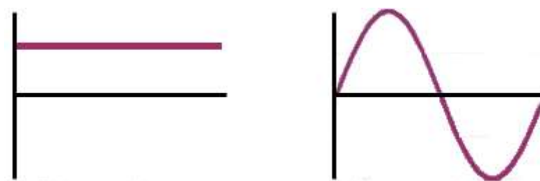
Figura 2.2 – Indicativo da tensão em corrente contínua [esquerda], e em corrente alternada [direita]
