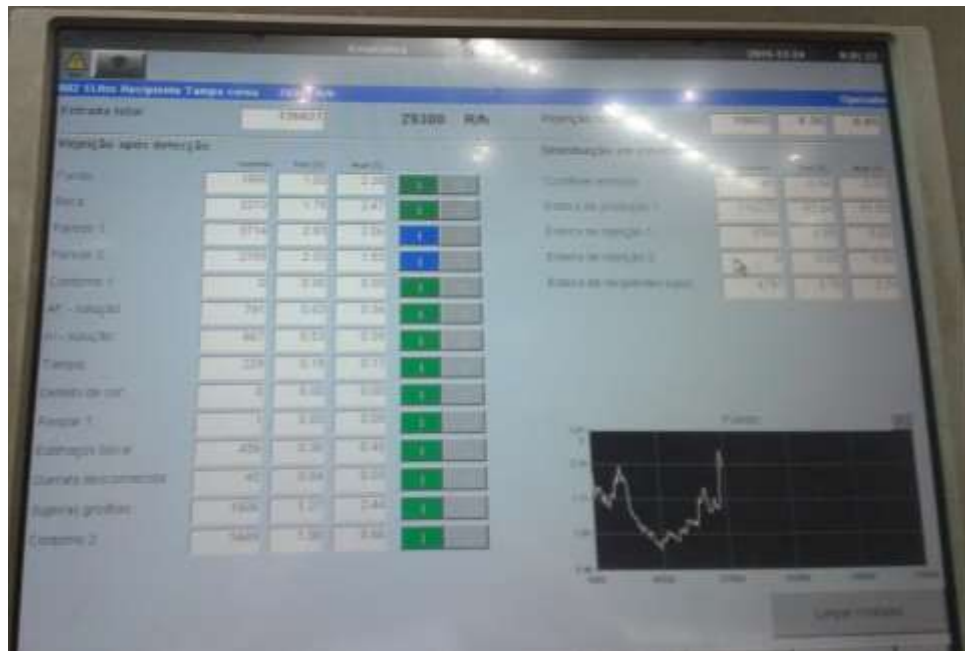
Figura 11 IHM de operação do Inspetor Eletrônico de Garrafas Vazias - Toptronic
