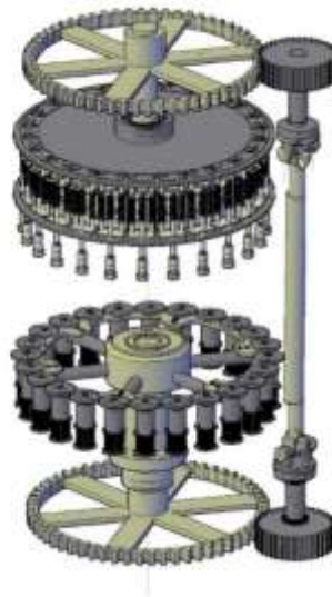
Figura 16 Esquema ilustrativo do Subsistema Perno de Centragem
