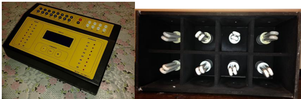
Imagem 1 Foto do dispositivo de testes de lâmpadas.
