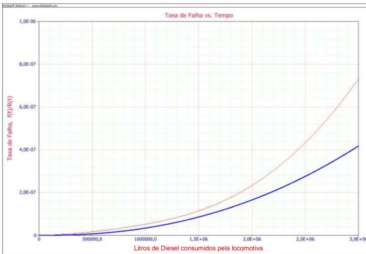
**Gráfico 5 – Taxa de Falha x Tempo – Modo de Falha “Passagem de óleo”**
