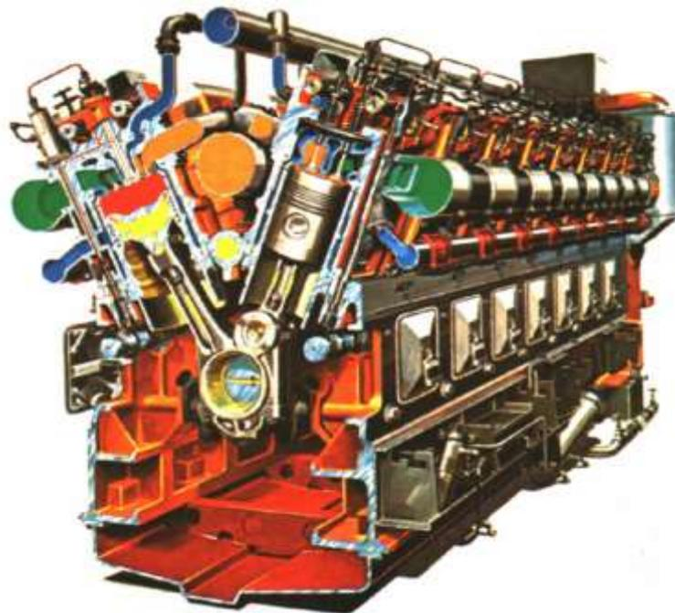
**Figura 4 – Motor Diesel em corte**
