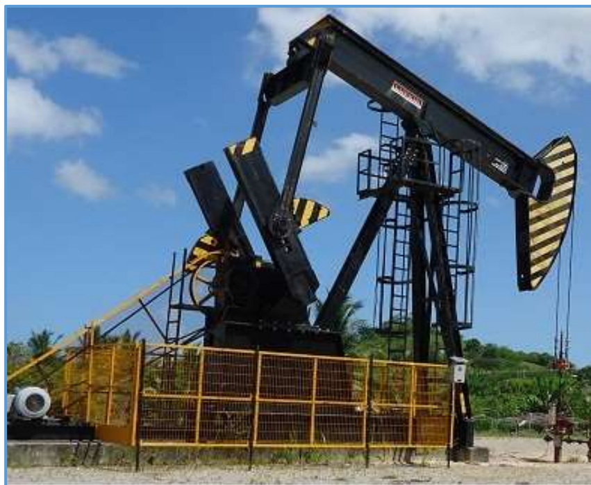
Fotografia 1 - Unidade de Bombeio Mecânico na produção de petróleo em terra
