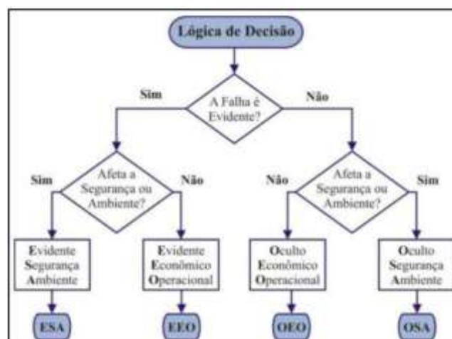
Figura 22 – Lógica de classificação das consequências da falha.
