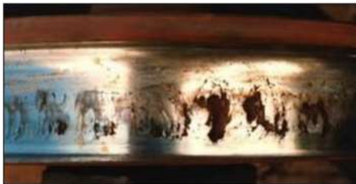
Figura 15: Roda com descascamento
