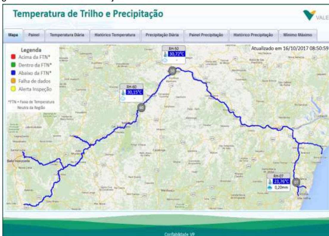
Figura 9 – Locais de instalação dos Termômetros
