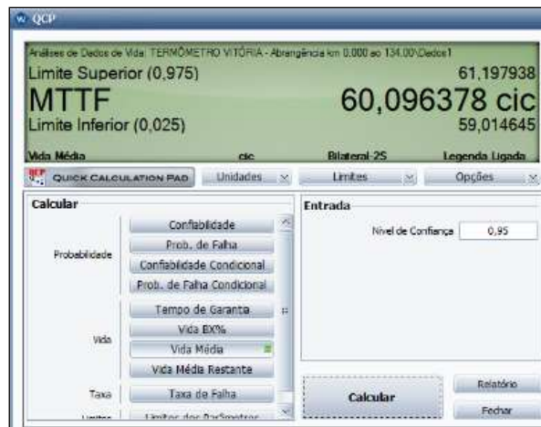
Figura 15 – Cálculo da Temperatura Média de Falha Termômetro Vitória
