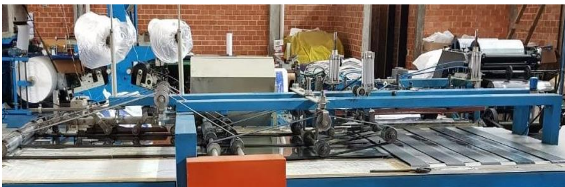
Fotografia 2.8 – Máquina de corte e costura (vista lateral).
