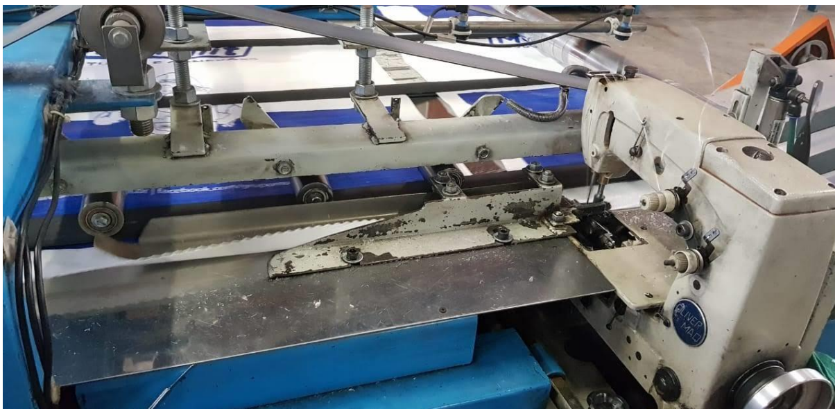
Fotografia 2.9 – Processo de dobra e costura da base da rafia.
