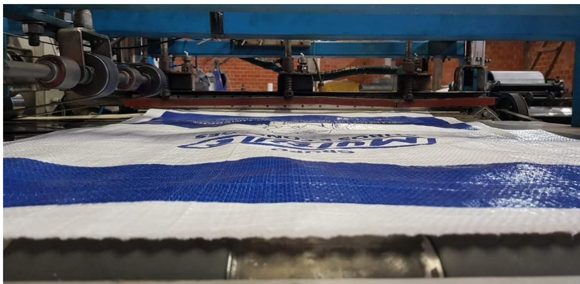
Fotografia 2.7 – Processo de corte da rafia.
