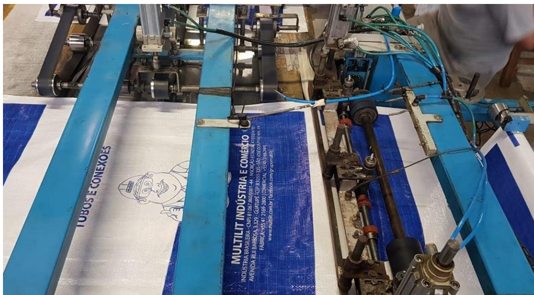
Fotografia 2.6 – Tracionador direcionando a rafia para o corte.
