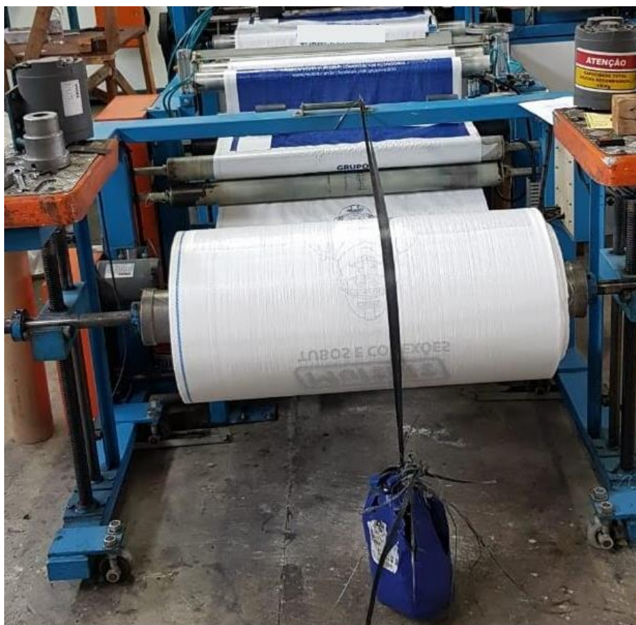
Fotografia 2.5 – Processo de desbobinamento da ráfia.
