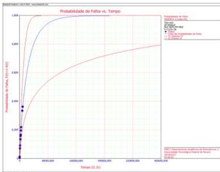
Figura 4.9 - Probabilidade de Falha vs. Tempo Yaw Axis
