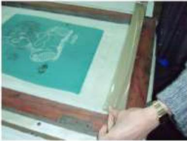
**19** Bloquear com fita cola de papel ou adesiva os quatro lados do quadro, metade sobre a rede e metade sobre o marco para que a tinta não se infiltre.
