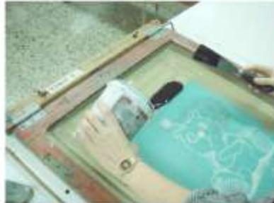
**23** Aplicar tinta o suficiente para imprimir.
