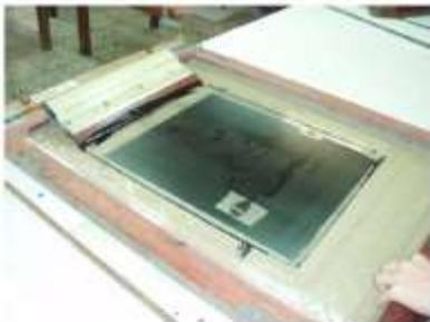
**25** Levantar o quadro e arrastar para cima novamente, pousar raquetele sobre o marco e colocar bloco de madeira entre a base e o quadro para que se mantenha levantado e assim retirar o papel.
