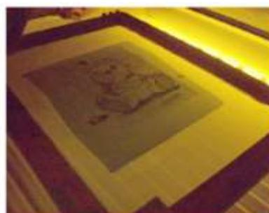
**8** Colocar o quadro com a rede em contacto com o vidro, sobre o fotolito.
