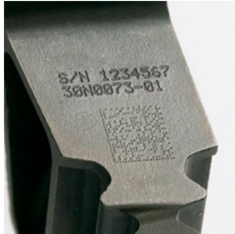
Figura 6 – Gravação por micro-percussão (punção) Fonte: TECHNIFOR (2016)
