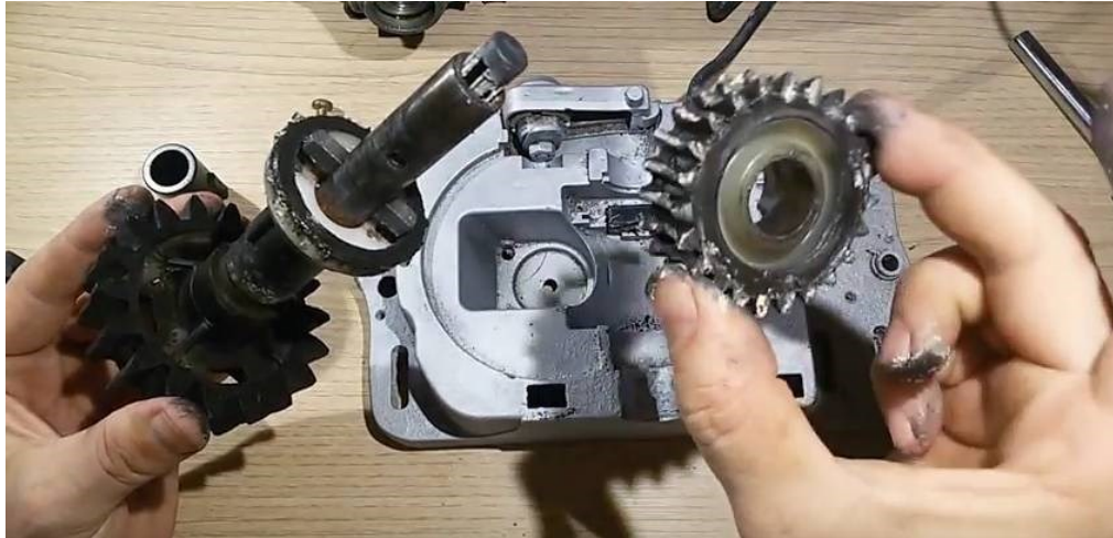
Figura 3: Engrenagem sendo substituída Fonte: Tectron Seg (2017).
