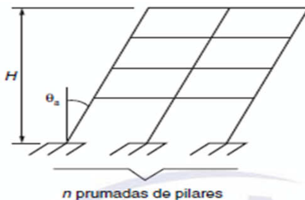
Figura 1 - Ângulo de desaprumo das edificações
