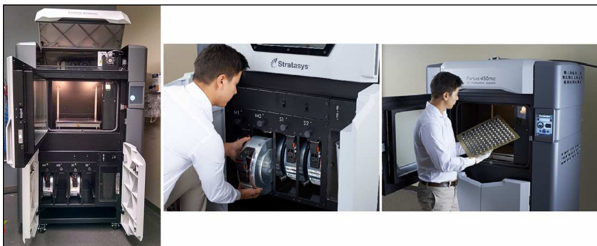
Figura 5 – Sistema de produção em impressão 3D baseada na tecnologia FDM Fonte: Adaptado de Javelin (2016), Stratasys (2016).
