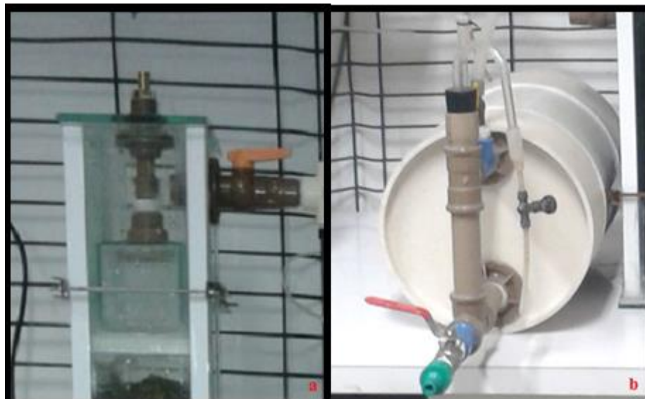
Figura 5 - a) Separador trifásico para coleta do biogás produzido, b) Sistema de medição do volume de gás por deslocamento líquido.
